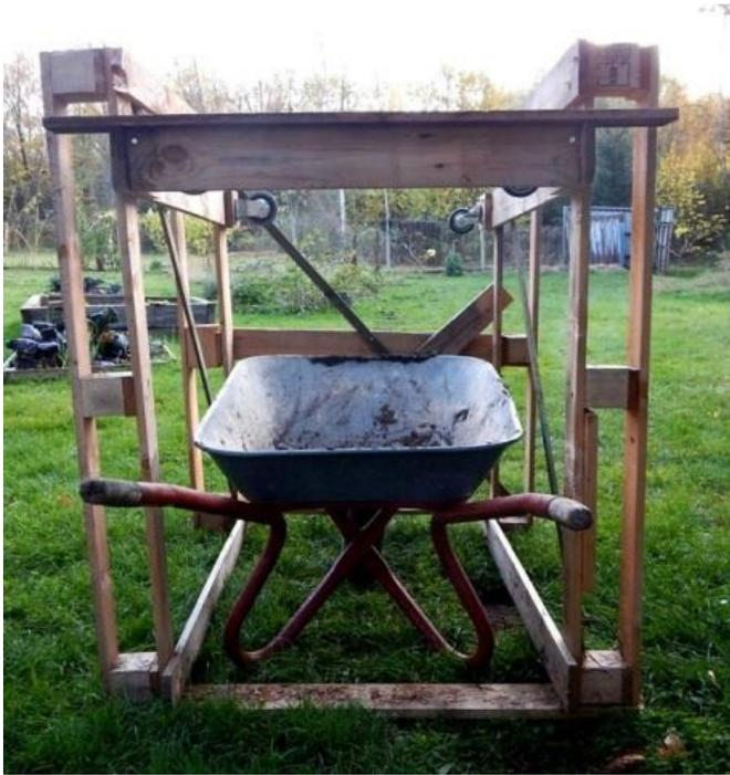
Wenn die Trommel voll mit Erde ist, drückt Sie aufgrund des **hohen Gewichts** die Rollen stark nach außen. Das muss von der Konstruktion kompensiert werden. Unsere erste Version war dafür zu schwach ausgelegt. Oben wurde der Rahmen auseinandergedrückt, unten ging er zusammen. Wir haben unten eine Strebe eingesetzt, die das verhindert.
