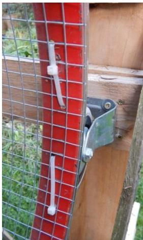
Die Felgenreifen werden nun mit dem Drahtgeflecht zu einer Trommel verbunden. Der Draht wird **INNEN** in den Ringen befestigt (Außen laufen ja später die Rollen). Die Felgenreifen haben bereits Löcher, in denen vorher die Speichen steckten. Wir haben das Drahtgeflecht dort mit **Kabelbindern** befestigt. Wer Plastik vermeiden möchte, kann stattdessen Draht verwenden. Soll das Drahtgeflecht überstehen? Wir haben das nicht für nötig gehalten und die
