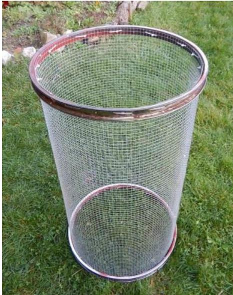
Wir haben keine Verbindungsstangen zwischen den Felgenreifen oder einen dritten Felgenreif in der Mitte verwendet. Die Rolle ist in unserem Fall allein durch das Drahtgeflecht stabil genug. Das macht die Rolle leicht. Bei einem dünneren Drahtgeflecht können Verbindungen/Verstärkungen nötig werden.
