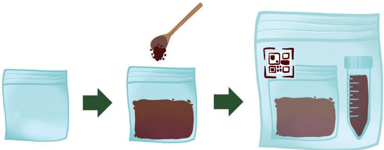
Abbildung 8: Verfahren zur Entnahme von Bodenproben für die Bewertung von Schwermetallen und Nährstoffen im Labor.
