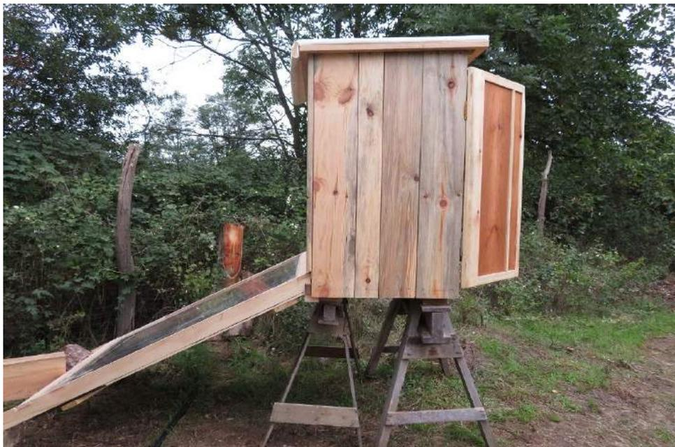
Wenn ein nicht verstellbares Modul gebaut wird, ist der optimale Winkel 30°, um den Einfall der Sonne möglichst optimal auszunutzen.
