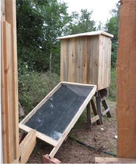
Schließlich wird natürlich noch das Modul benötigt, welches mittels Sonnenenergie für die Erwärmung der Luft im Kasten sorgt.
