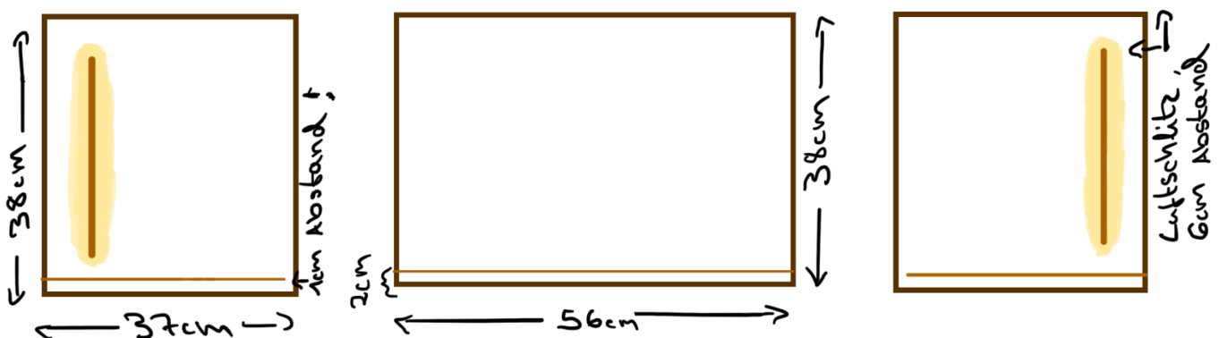
Bild 1: Seitenwand links, Bodenplatte und Seitenwand rechts mit Nuten (hellbraun), Luftschlitz und Vlies (gelb).
