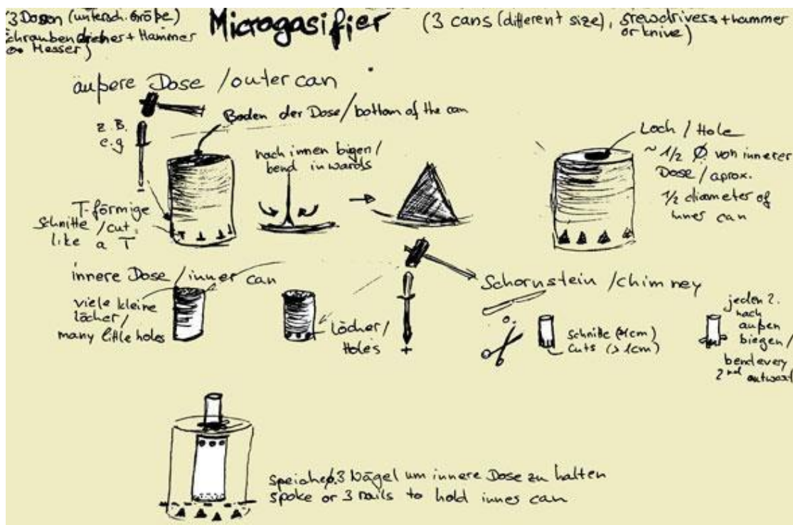
Bauanleitung in Wort und Bild von „bauraum-lowtech“
