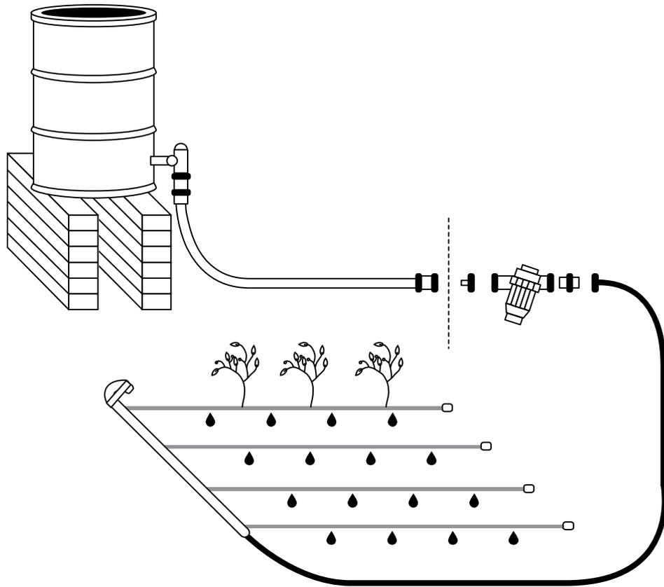
**1. Arbeitsschritt:** Aus den Paletten und den Querverstreben wird mit Hilfe der Holzschrauben ein stabiles Podest gebaut, das auf einem ebenen Untergrund standfest aufzustellen ist. Darauf wird der Wasserauffangbehälter positioniert. Ganz wichtig ist dabei, dass das Podest das Gesamtgewicht tragen kann und der Behälter gegen Verrutschen gut gesichert wird (durch Holzrahmen, Spanngurte o. dgl.).
