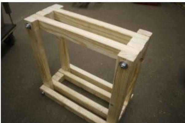
Zunächst bauten wir ein Gestell aus einfachen Holzleisten, das den Pressdruck von bis zu 4 Tonnen aushalten muss. Dafür schraubten wir es mit Gewindestangen zusammen. Als Pressschraube dient uns eine spezielle Gewindestange aus Edelstahl (sie darf ja nicht rosten). Das Gewindegegenstück dazu schweißte Martin auf einer starken Metallplatte auf, die wir dann am Holzgestell festschrauben konnten.
