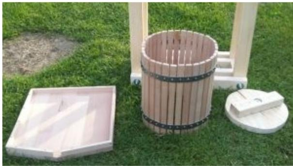
verbindenden Querriegel auf, der in der Mitte eine kleine Vertiefung und eine Unterlegscheibe bekam, damit er nicht an der Pressschraube herumschneidet. Den Presskorb fertigen wir aus vielen schmalen glatt geschliffenen Holzleisten, die wir an zwei Edelstahlbänder schraubten, um sie zusammenzuhalten. Am Ende ölten wir alles mehrfach mit Tobias' selbstgemachter Leinölfirnis ein, um es vor Feuchtigkeit zu schützen.
